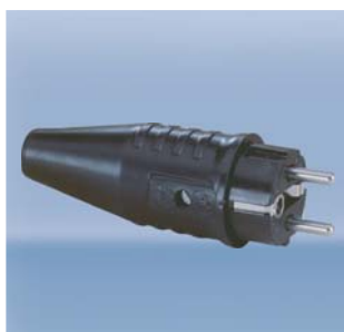
Vidlice celogumová zesílené provedení dle CEE 7/VII krytí IP 44 \text{⏏} pro vodiče do 3 x 2,5 mm 2
