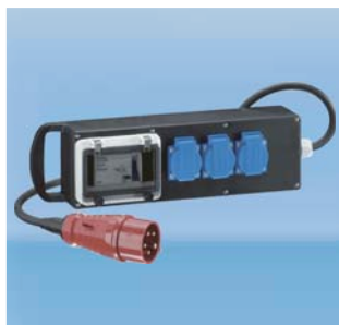
Gumový zásuvkový box 2 m H07RN-F 5 x 2,5 mm s vidlicí 400V/16A/5p. 3 zásuvky 230V/16A 1 pr. chránič 4/40/0,03 A
