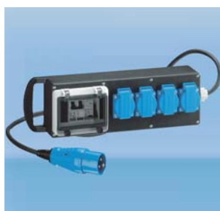
Gumový zásuvkový box 2 m H07RN-F 3 x 2,5 mm s vidlicí 230V/16A/3p. 4 zásuvky 230V/16A 1 pr. chránič 2/25/0,03 A 2 jističe 1B16
