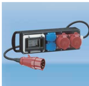
Gumový zásuvkový box 2 m H07RN-F 5 x 2,5 mm s vidlicí 400V/16A/5p. 2 zásuvky 230V/16A 2 zásuvky 400V/16A/5p. 1 pr. chránič 4/40/0,03 A
