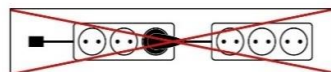
Zásuvky se spínači jsou bez napětí pouze tehdy, jestliže je odpojen přívodní kabel.
